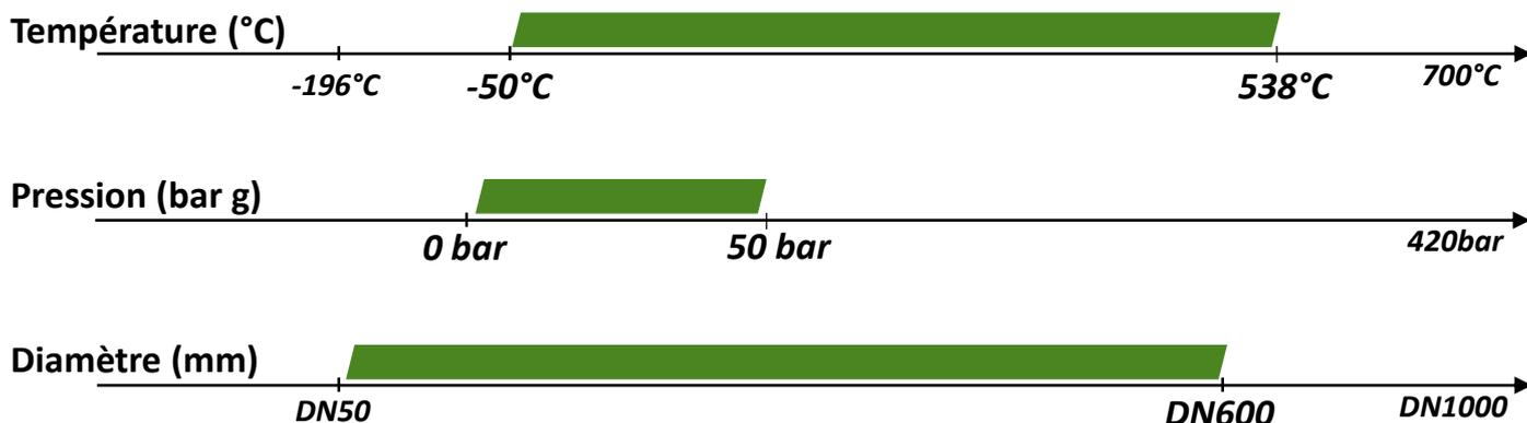
Les pressions et températures maximales dépendent de la relation pression/température et de la nature du fluide.
